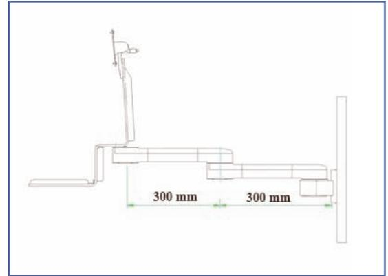
Ce bras combo pour écran, clavier et souris double extension possède trois points de rotation, l'une à l'extrémité de la rotule écran, une autre à sa deuxième extension et la dernière à sa fixation sur le mur.
